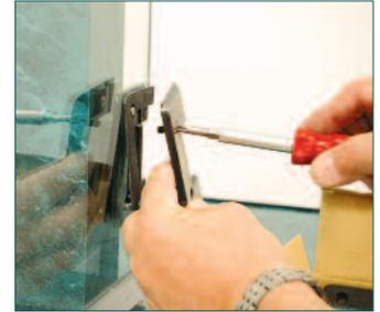
Installieren Sie eine neue Dichtung und innere Abdeckung, ersetzen die Schrauben und dann befestigen.
