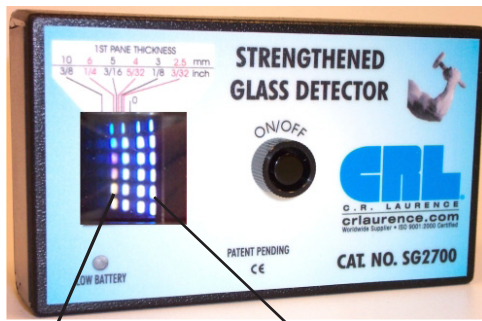
Figure 1: Contrôle d'une fenêtre à double vitrage à l'aide du SG2700. Veuillez remarquer qu'une colonne de réflexion apparaît pour chaque surface de verre.
