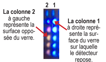
Figure 2: Réflexion d'un vitrage simple dans la fenêtre de visualisation
