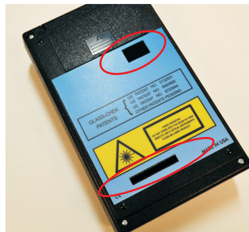
Abb. oben: Rückseite eines GC3200-Messgeräts mit zwei runden Linsen. Verwenden Sie saubere Druckluft, um die Linsen zu reinigen.
