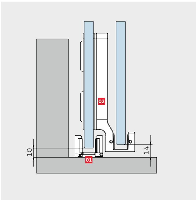
**Glasbearbeitung für mitfahrende Bodenführung**
