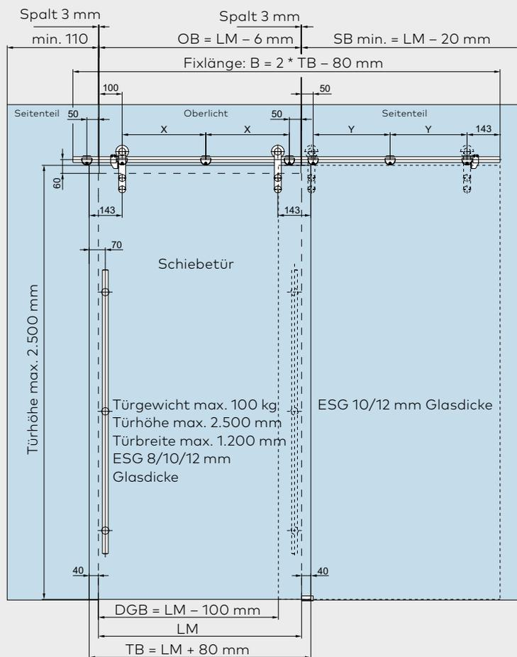
Für die Montage ist eine ausreichend dimensionierte und verwindungssteife Unterkonstruktion vorzusehen.
