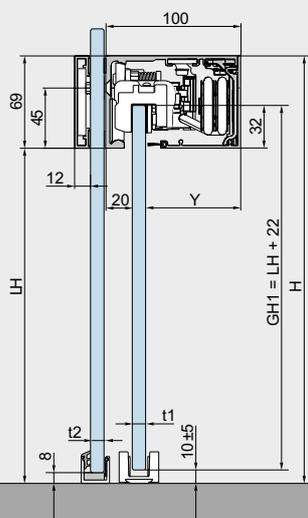
Um eine korrekt ausgerichtete Montage der Laufschiene zu gewährleisten, müssen die Festteile sicher installiert sein.
