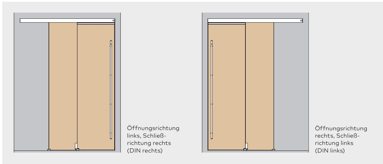
Öffnungsrichtung links, Schließrichtung rechts (DIN rechts)
