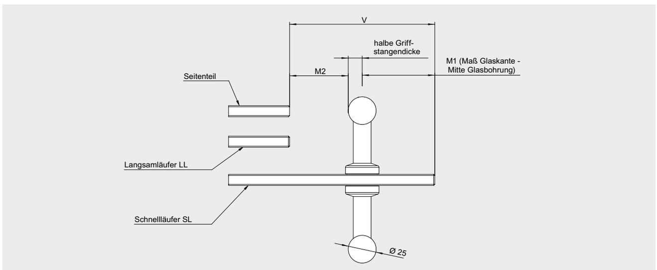
V = Überstand des Schnellläufers bei Anwendung mit Griffstange (siehe Detailblatt 36-747)
