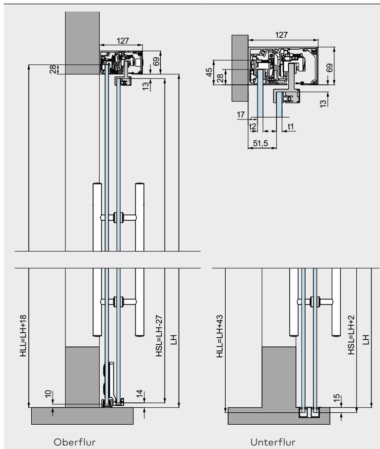
Zur Installation mit zwei Türflügeln zur Wandbefestigung, optional mit DORMOTION Einheit. Bei Verwendung einer DORMOTION-Einheit, empfehlen wir die Montage einer Griffstange.
