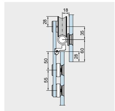
Bei den Maßangaben handelt es sich lediglich um empfohlene Werte. Bitte beachten Sie bei der Planung, dass die Positionen der Stopper und Punkthalter nicht übereinander liegen dürfen. Abstandsempfehlungen für die Laufschienenbohrung und erforderliche Maße zur Befestigung der Laufschiene entnehmen Sie bitte der Tabelle „Abstandsempfehlung der Laufschienenbefestigungspunkte“.
