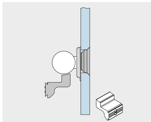
Zur Sicherung des Flügels kommt ein entsprechender Aushebeschutz zum Einsatz.
